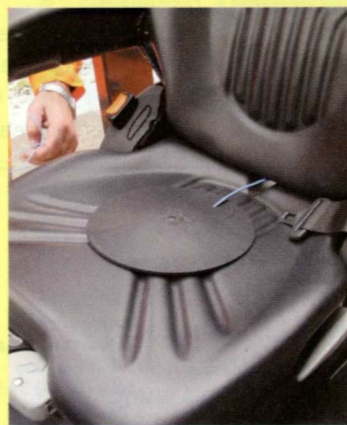
De sensor registreert tijdens de rit in drie richtingen de schokken die het lichaam te verwerken krijgt
