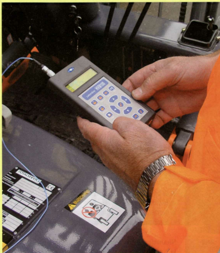
De meetgegevens worden in de ontvanger opgeslagen en kunnen later in de computer worden verwerkt tot een duidelijk testrapport
